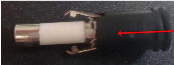
Abbildung 23 Herausziehen der Sicherung
