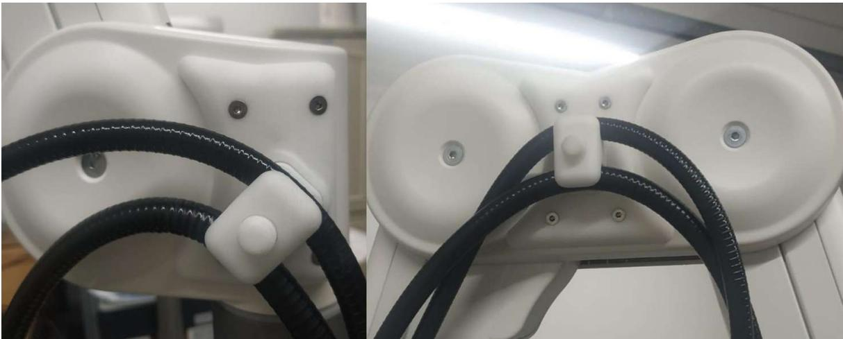
Abbildung 15: Kabel im Kameraarm befestigt
