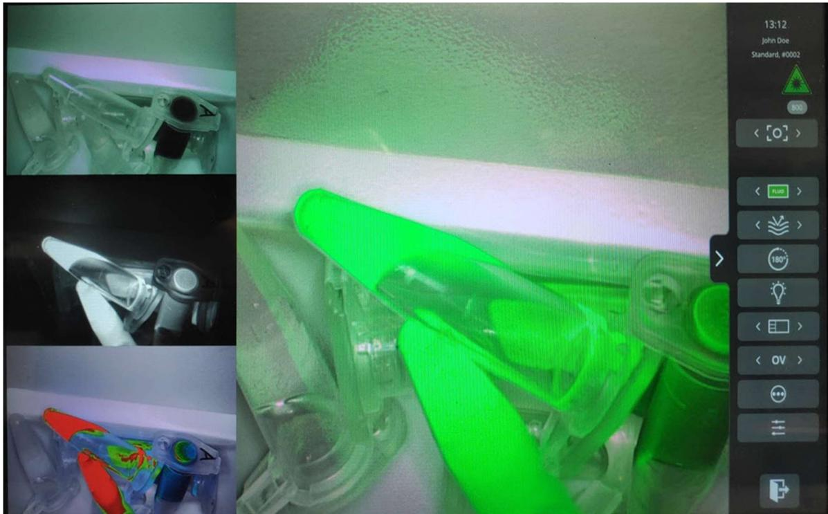
Abbildung 10: Ansicht des Operationsmodus (ICG). Das Hauptbild entspricht dem Overlay (OV)-Modus. Links von oben nach unten: RGB, NIR-, GR-Modi.
