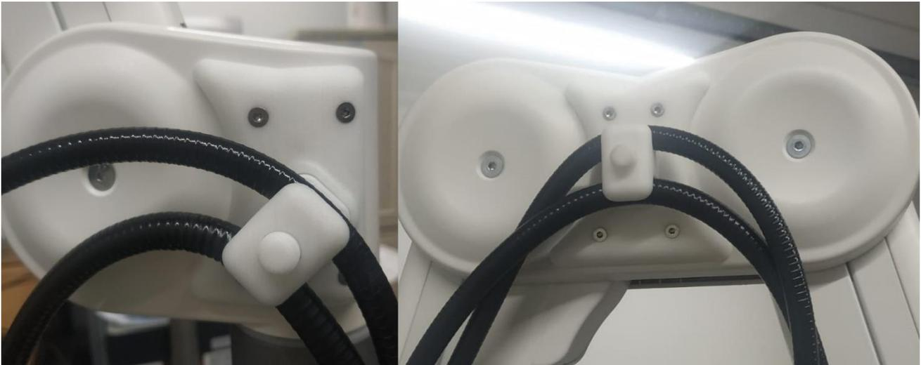
Abbildung 15: Kabel im Kameraarm befestigt
