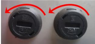
Abbildung 22: Ersetzen von Sicherungen
